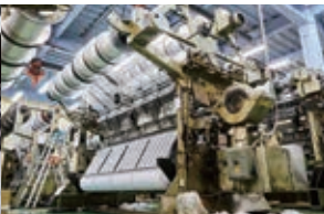
北陸工場開設当時から稼働する経編「ラッセル機」
